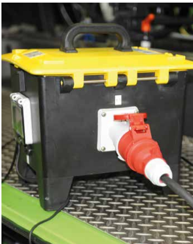
Mit Spannungspfad - Zufuhr über CEE
