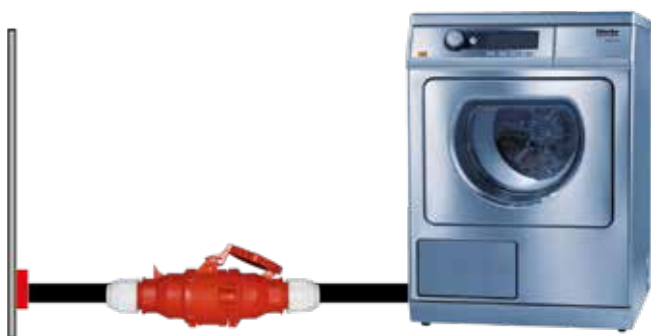
Anschluss über verschließbare Steckvorrichtungen
